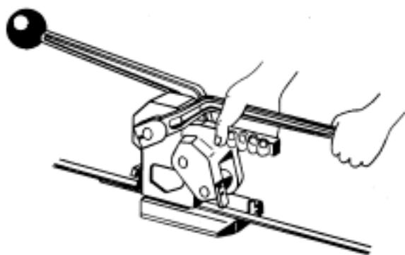
**D Werkzeug aus Umreifung lösen**
