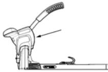
**S** Hur hårt klammern skall klämmas ihop kan justeras. Vrid justeringsmuttern med en 3 mm insexnyckel medurs för en hårdare bockning och moturs för en mer öppen klammer.
